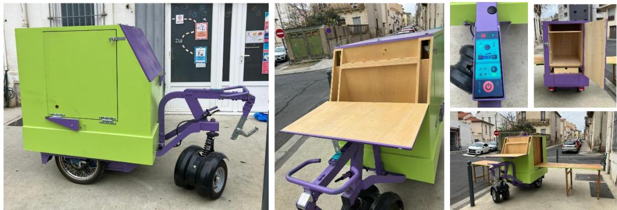
**Remorque** K-Ryole Kustom à trois roues / Option Fort Couple + Batterie lithium 1,6 kWh rackable
